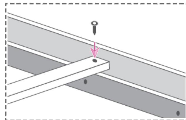
Positionnez le motnant de maintien d'espacement, il doit être parfaitement plaqué contre les 2 parois
