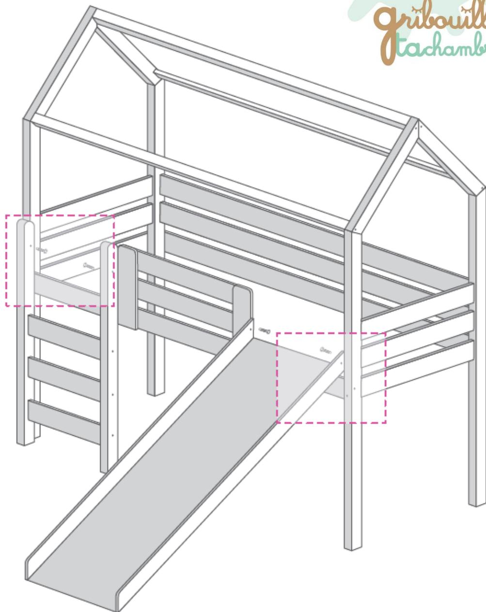
Fixez l'échelle par les 2 vis 55mm depuis l'intérieur du lit + la vis côté barrières centrales (à gauche ou à droite selon le côté où se trouve votre échelle.)
