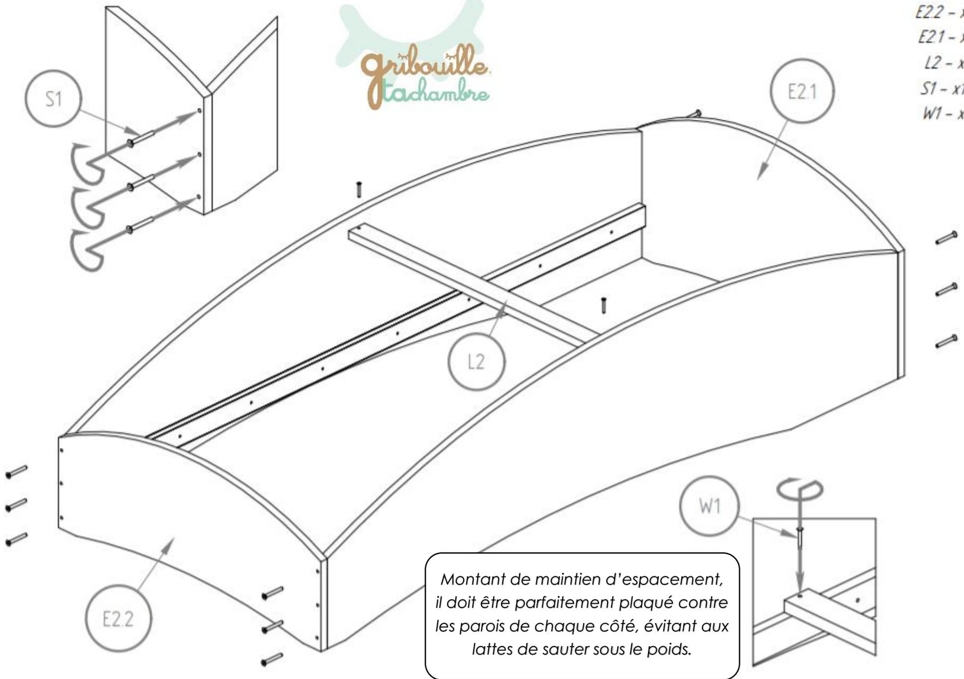
Montant de maintien d'espacement, il doit être parfaitement plaqué contre les parois de chaque côté, évitant aux lattes de sauter sous le poids.
