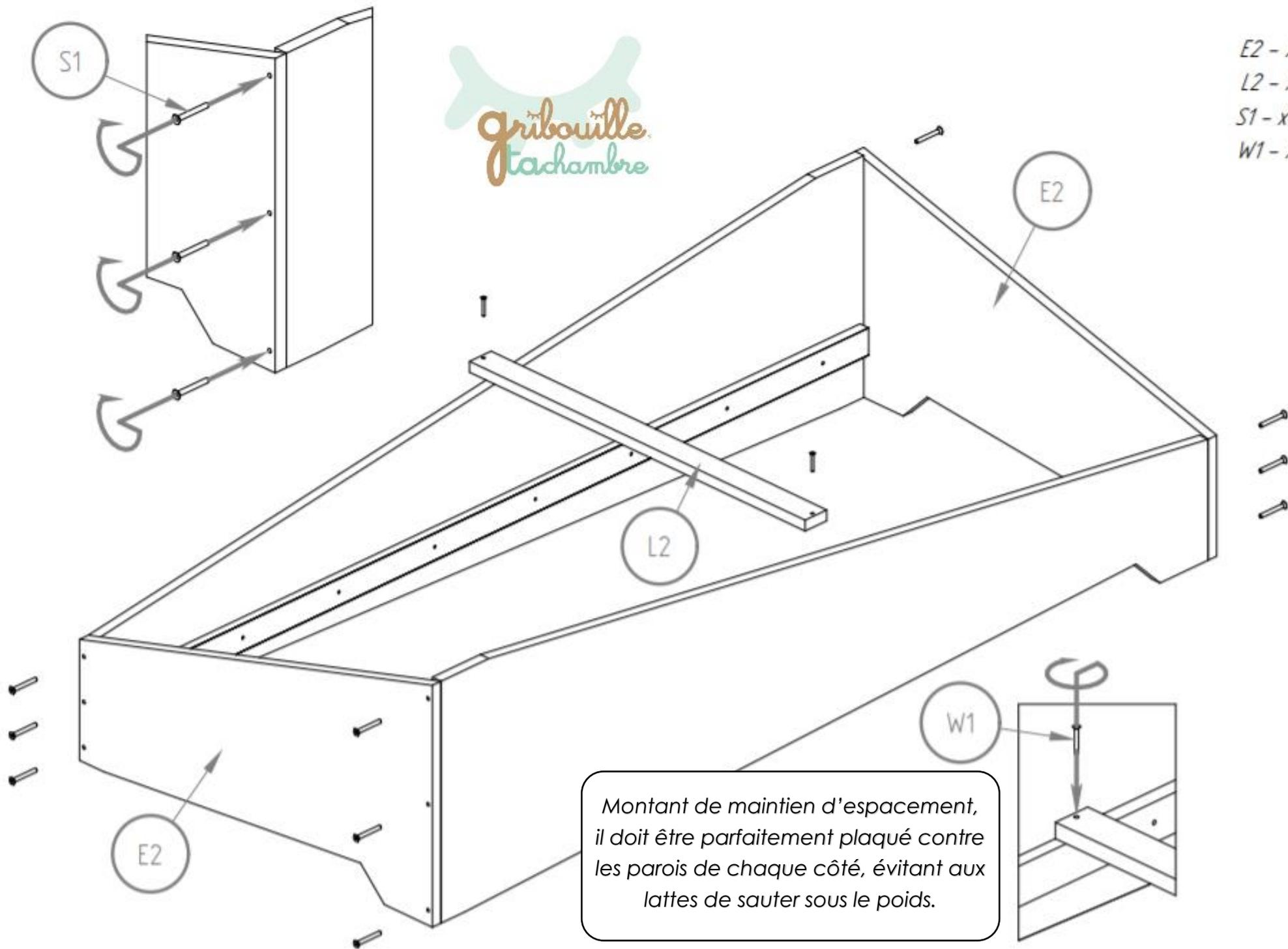
Montant de maintien d'espacement, il doit être parfaitement plaqué contre les parois de chaque côté, évitant aux lattes de sauter sous le poids.
